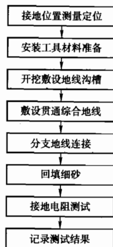
图 13.5.2—1 综合接地施工工艺流程图
