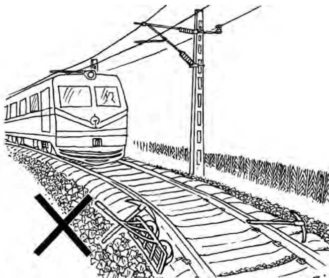
图 10.2.7 严禁施工机具侵入限界
