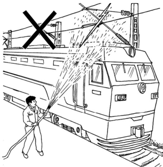
图 9.4.9 接触网带电时严禁用水管冲洗机车车辆
