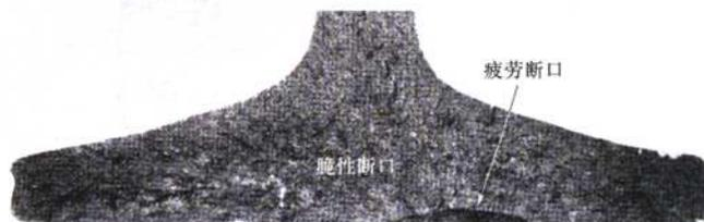
图 31 起源于轨底下表面的横向疲劳断裂形状示例图(伤损编号 1650)
