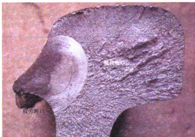
图 5 轨头下颚辗边处形成裂纹源并发生横向疲劳断裂示例图(伤损编号 0111)
