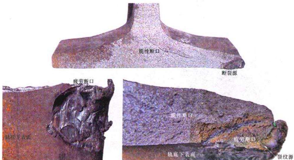
图 35 轨底角火焰烧伤引起的疲劳断裂示例图(伤损编号 1660)
