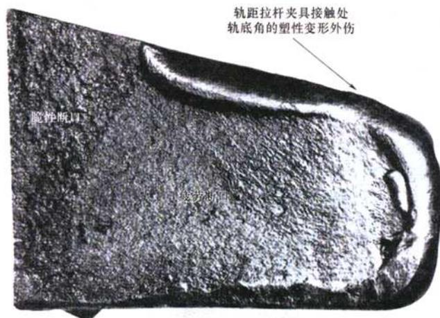
图 34 轨距拉杆处轨底角外伤引起的疲劳断裂示例图(伤损编号 1660)
