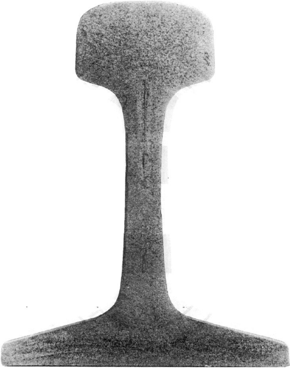
图 C. 4 延伸至轨头的中心轨腰条纹
