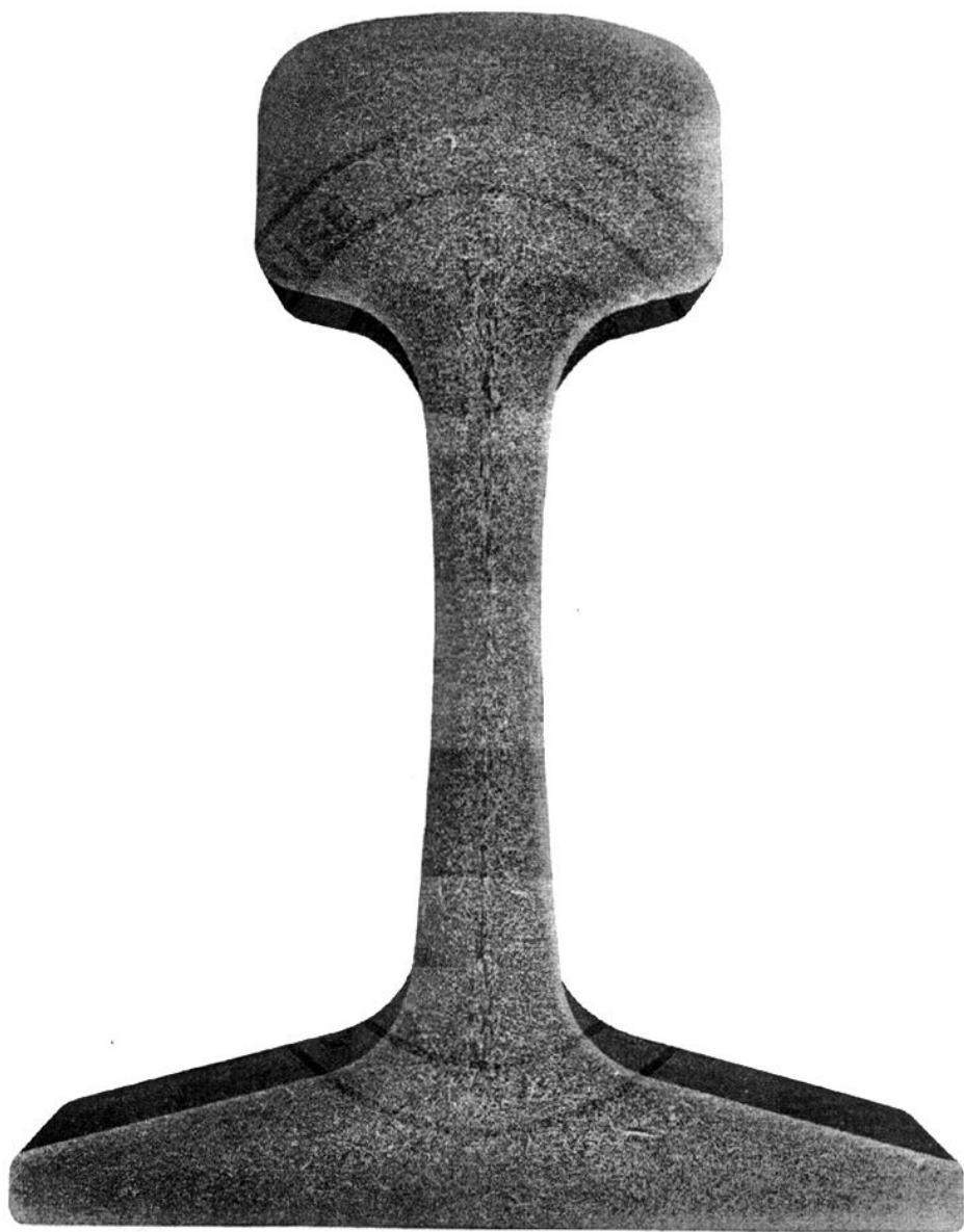
图 C.7 从轨腰延伸到轨头和轨底的分散分布的中心轨腰条纹
