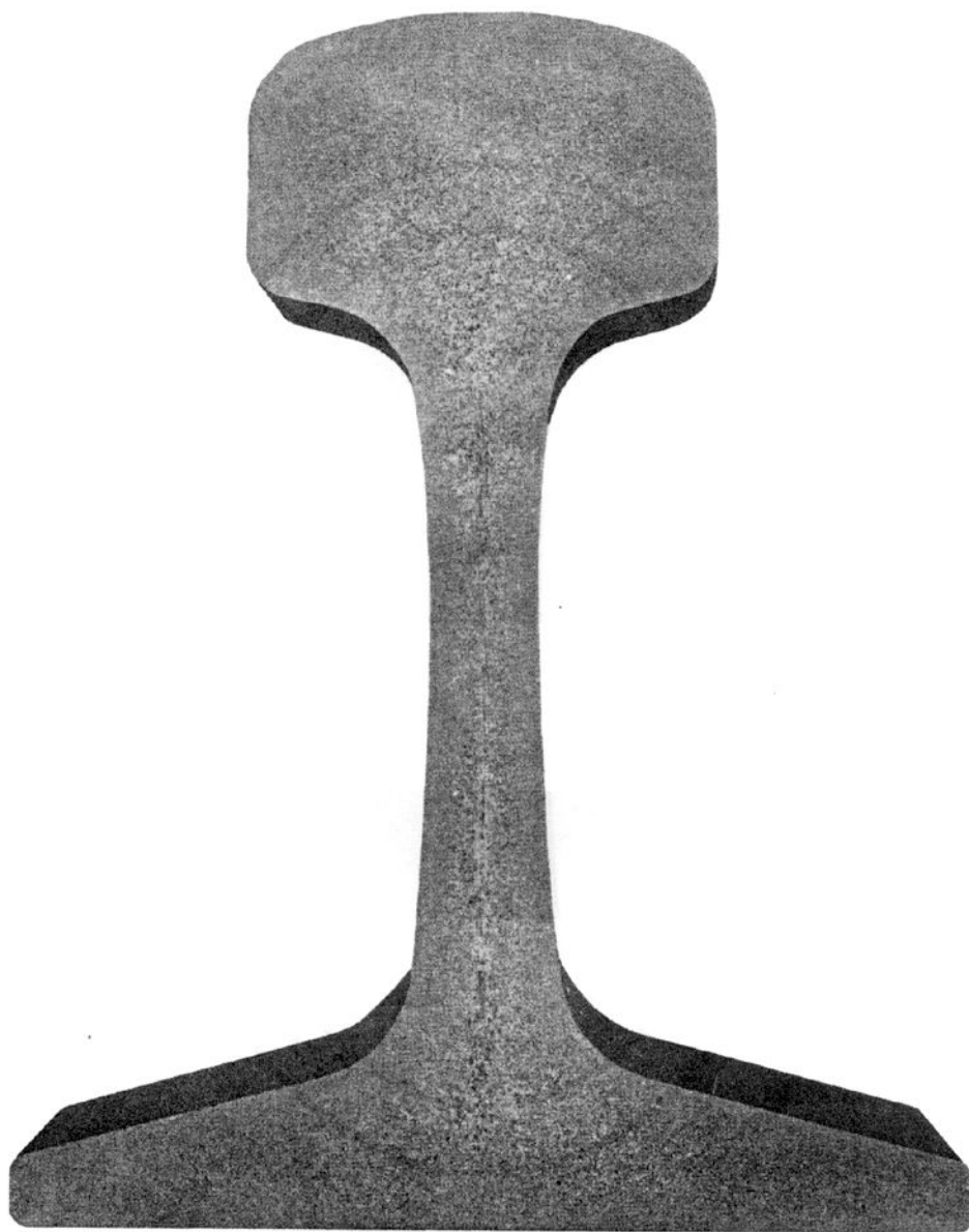
图 C. 5 延伸至轨底的中心轨腰条纹
