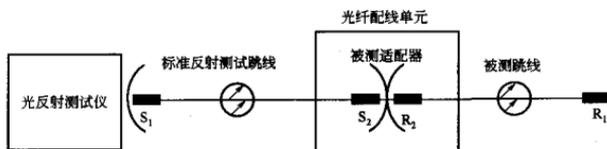
图 6 光纤配线单元回波损耗测试图
