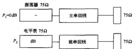
图 11 近端串音衰减试验接线图
