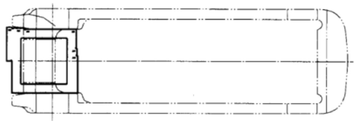
图 A.20 17 型钩尾框内腔高检查示意图
