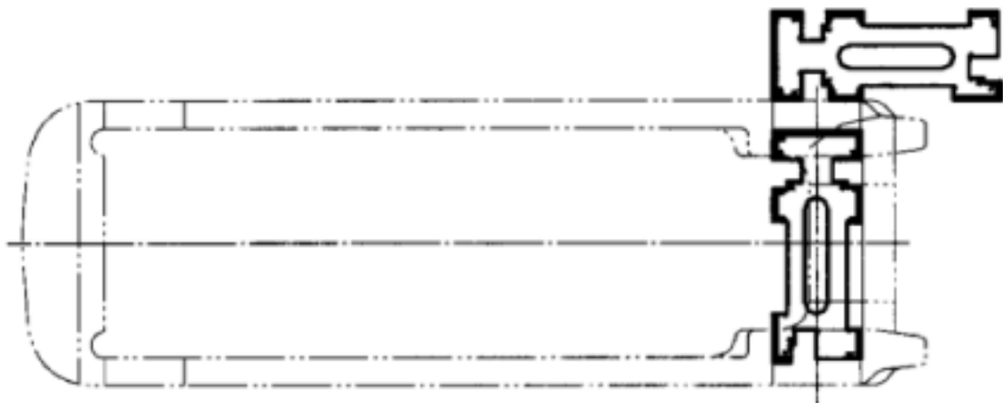
图 A. 17 17 型钩尾框钩尾销孔检查示意图
