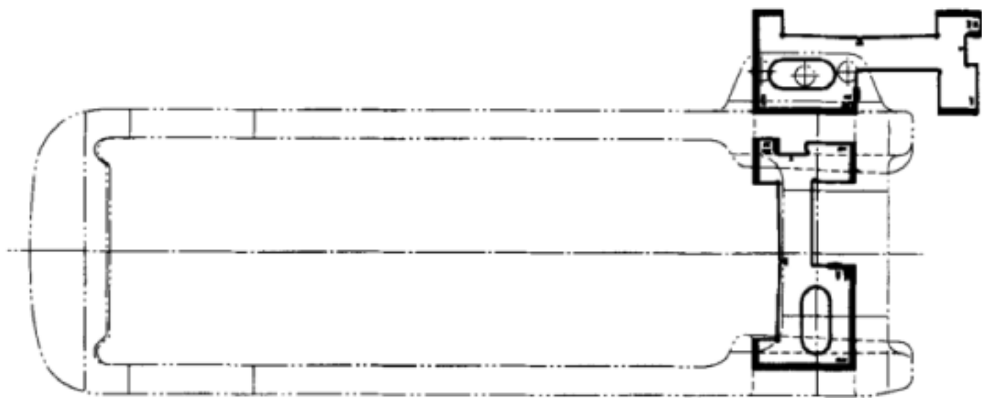
图 A.3 13B 型锻造钩尾框钩尾销孔检查示意图
