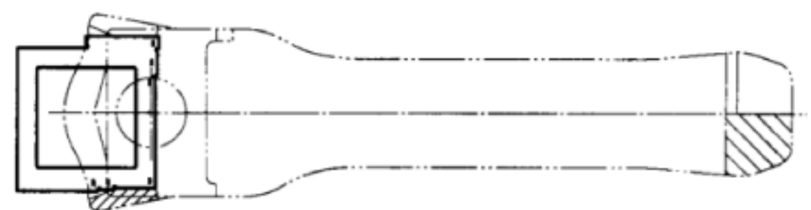
图 A.21 17 型钩尾框内腔宽检查示意图
