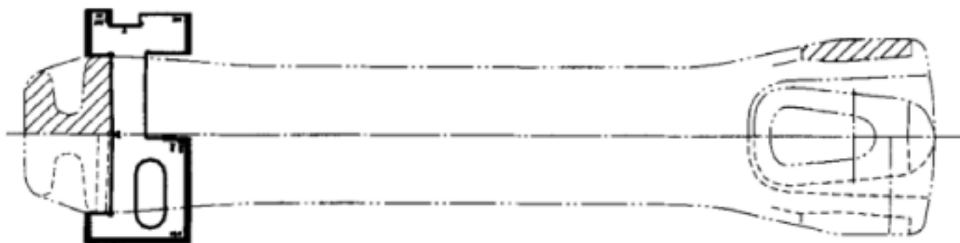
图 A.4 13B 型锻造钩尾框后端面检查示意图
