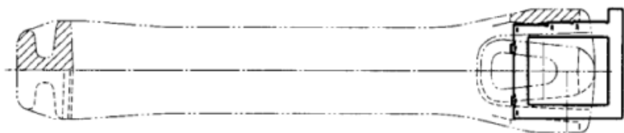
图 A. 9 13B 型锻造钩尾框内腔宽检查示意图
