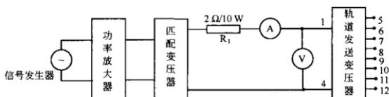
图8 轨道发送变压器输出电压、495 Hz 开路阻抗测试电路
