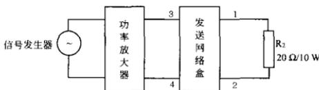
图 11 发送网络盒传输特性测试电路
