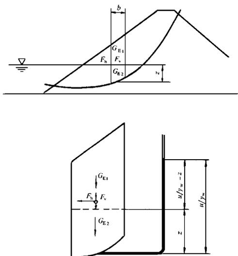
图 A1 圆弧滑动条分计算示意图
