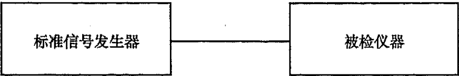
图 3 标准源法频率测量误差检定示意图
