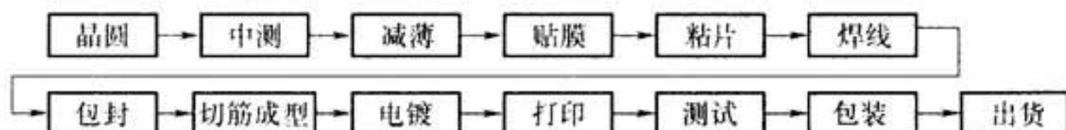
**A.0.2** 球栅阵列封装宜采用下列生产工艺流程：
