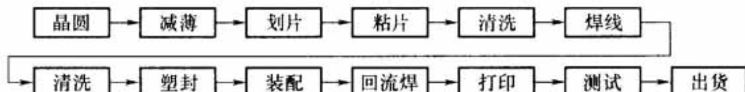
**A.0.3** 晶圆级封装宜采用下列生产工艺流程：
