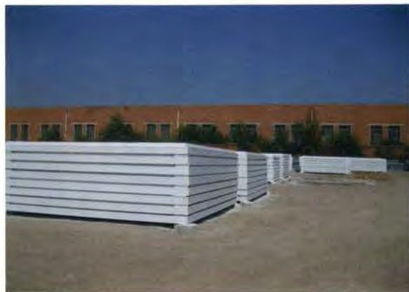
钢框轻型屋面板成品堆放
