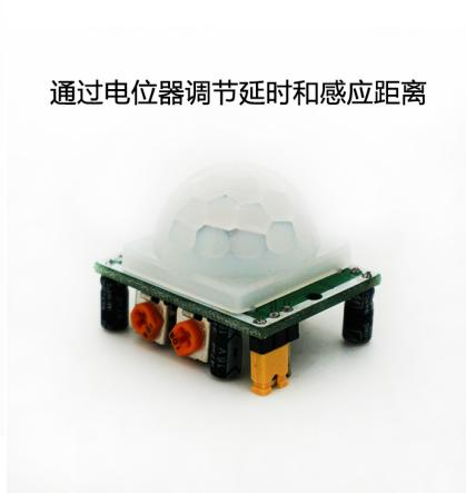
一个输出引脚连接单片机IO口
