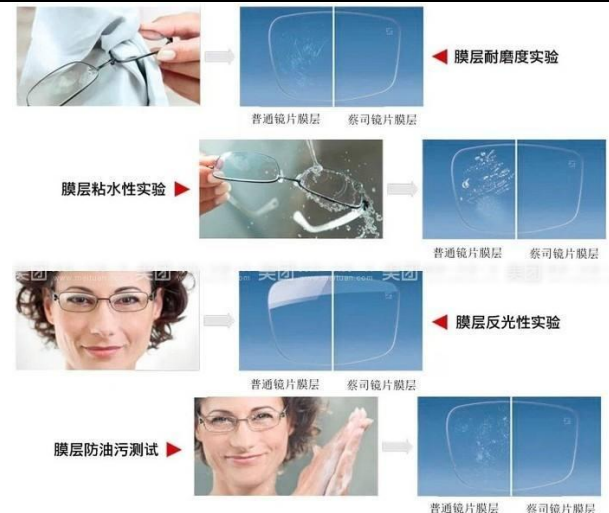
图 2：镜片膜层一般需做耐磨、防油污等测试
